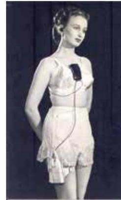
Transistorhörgerät aus den 50er Jahren konnte diskret unter dem Kleid getragen werden
